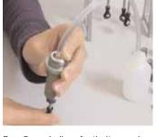
Den Gegenkolben festhalten und die Kolbenstange langsam einfahren.
