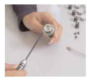
Den Entlüftungsnippel herausschrauben und die Verschlussschraube mit dem O-Ring einschrauben.
