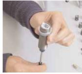
Jetzt die Kolbenstange langsam nach unten ziehen. Der Gegenkolben sollte dabei 2 · 3 mm mit nach unten gezogen werden.
