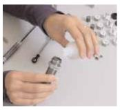
Öl in die Dämpfer einfüllen, bis ca. 4 mm unter der Oberkante. Anschließend die Dämpfer ruhen lassen, bis keine Luftblasen mehr im Öl zu sehen sind.
