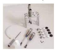
Die Stoßdämpfer bis auf Gegenkolben, Druckfeder und Dämpferkappe komplett montieren.
