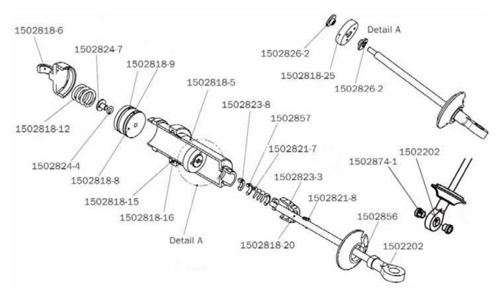
1502818 Stoßdämpferset Big-Bore mit Gegenkolben, 4 Stk./Damper set big bore with opposed piston, 4 pcs.
